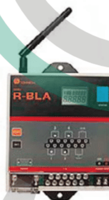
R-BLA - специализированный приемник для трансмиттеров серии BL.
